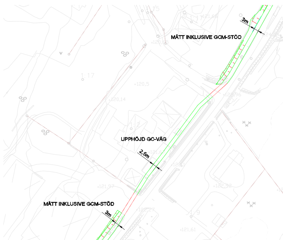
Figur 5: GC-vägen läggs innanför den västra stenmuren.
